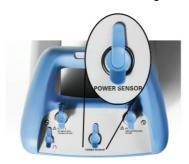
Der Anschluss ist speziell für Leistungsmessköpfe konfiguriert. Er wird sowohl zur Stromversorgung als auch für Datenübertragungen über die Schnittstelle des Leistungsmesskopfs verwendet.
