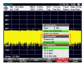
Der Betrag der Verstärkung ist vom Referenzpegel abhängig. Diese Kopplung an den Referenzpegel stellt sicher, dass der Dynamikbereich optimal ist.
