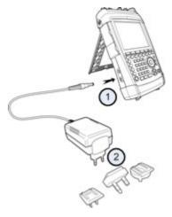
Der Spannungsbereich des Netzteils beträgt 100 V bis 240 V AC.
