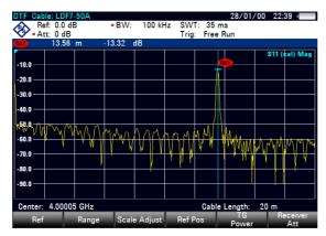
Eine blaue, vertikale Linie zeigt die Position des Markers auf der horizontalen Achse (z. B. der Frequenz).
