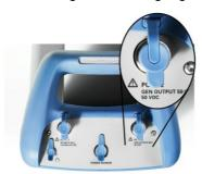
Die Leistung am Mitlaufgeneratorausgang des R&S FSH beträgt 0 dBm nominal.
