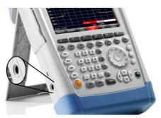
Über den DC-Anschluss wird der R&S FSH vom Netzteil des AC/DC-Wandlers mit Strom versorgt. Auch der Akku kann über den DC-Anschluss geladen werden.
