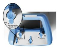
Ein Kabel oder Messobjekt wird mit einem N-Stecker an den HF-Eingang angeschlossen. Der Anschluss des Messobjekts an den R&S FSH kann bei Bedarf über ein Kabel erfolgen.
